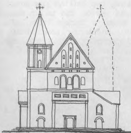
7 pav. Jėzuitų vienuolyno bažnyčios pagrindinio fasado schema, sudaryta pagal 1823 m. brėžinį
